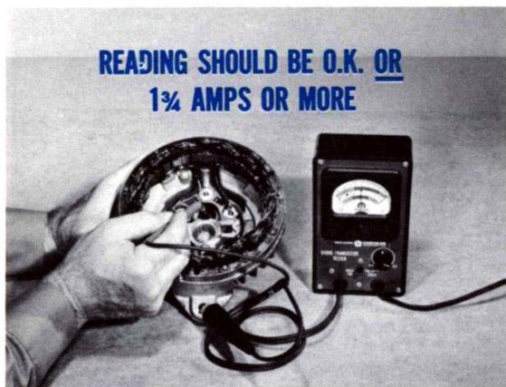
Fig. 36—Rectifier Test
