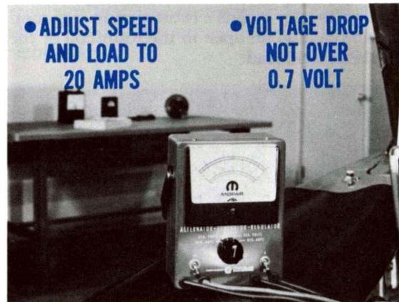
Fig. 26—Voltage-Drop Test
